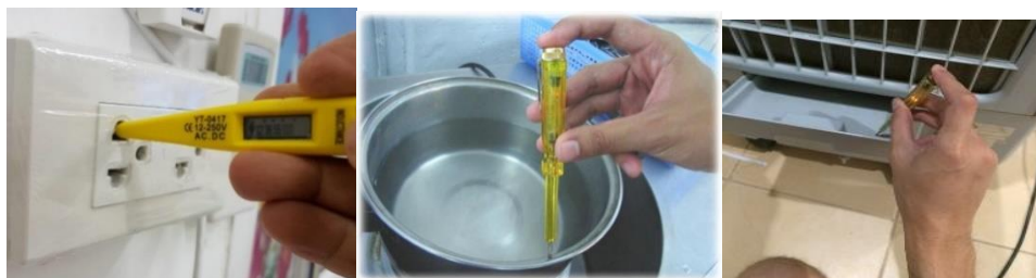
ภาพที่ 1.2 การใช้ไขควงลองไฟทดสอบไฟรั่ว
